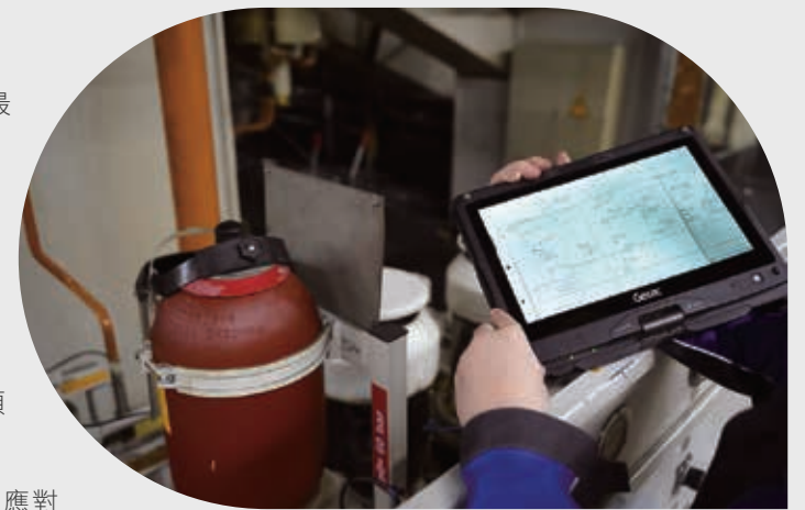
▲ Getac V110 通過 MIL-STD-810H、MIL-STD-461G 和 IP65 認證，可承受震動、粉塵、水／液體以及 -29°C 至 63°C 的極端溫度等惡劣條件。不僅如此，強固型 Getac ATEX 設備也已投入使用，以應對潛在爆炸風險的作業環境。
