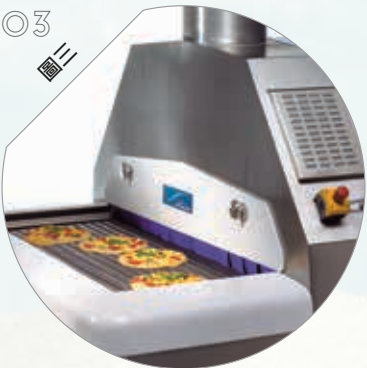
聯華林德隧道冷凍機
