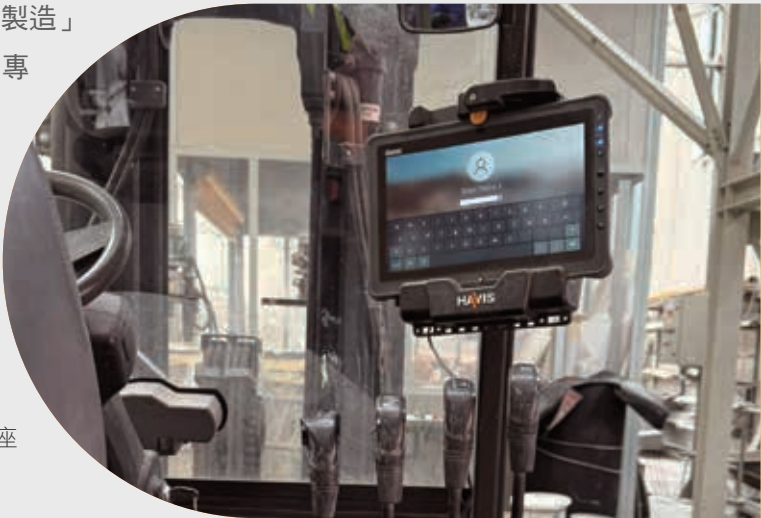
▲ Getac F110 配備大型 11.6 吋觸控螢幕，採用 LumiBond 2.0 技術，亮度高達 1000nits，確保在各種條件下（包括陽光和雨中）都具有良好的可讀性。
