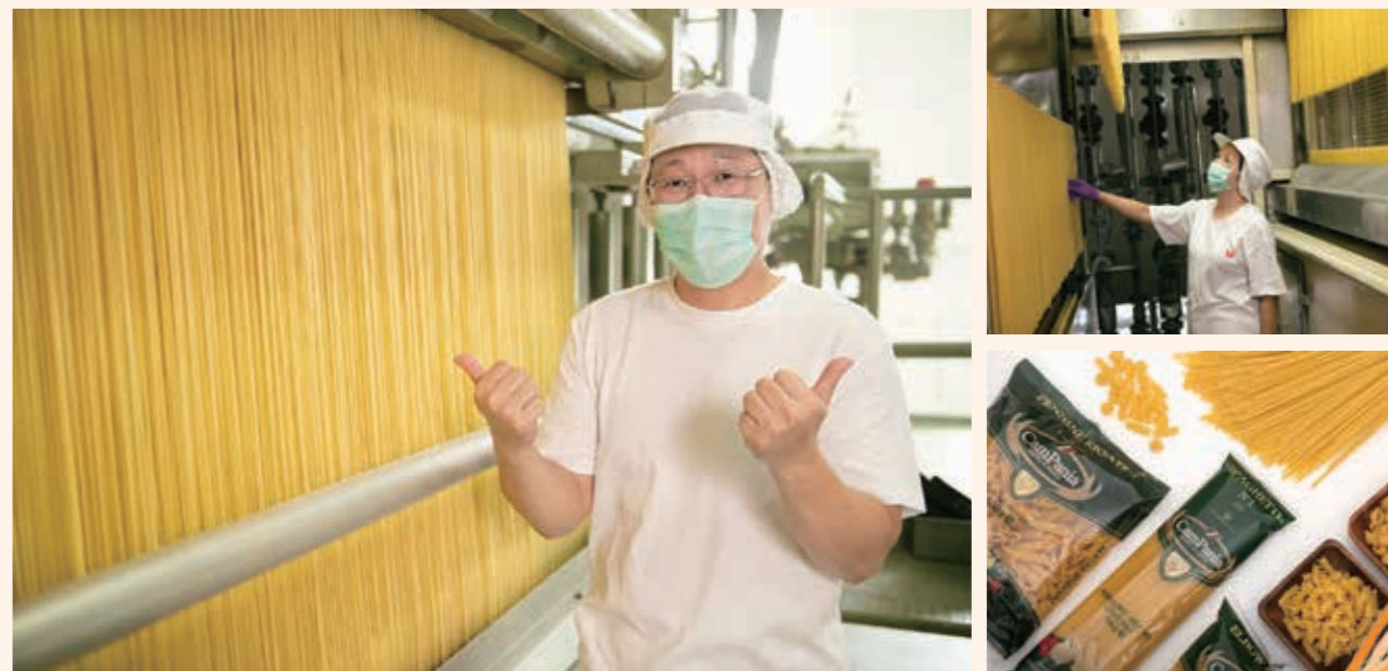
▲全自動化產線的義大利麵：富岡義大利麵加工廠，使用世界級瑞士 Buhler 生產設備，生產長麵及短麵兩大類義大利麵，採用新鮮優質的杜蘭沙粒粉，經由攪拌、成型、乾燥、冷卻、包裝，生產的義大利麵香滑而極富彈性，適合各式不同風味的義大利料理。
