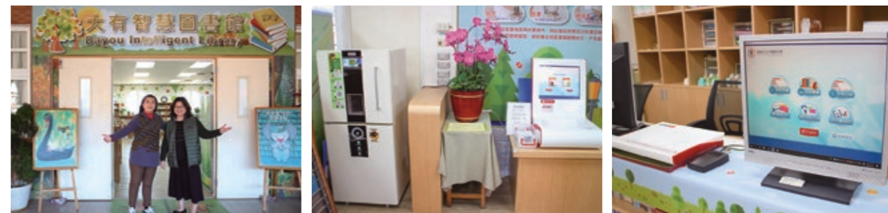
▲左圖：在大有國中服務多年的志工媽媽。中圖：IDSmart 圖書除菌機與桌式自助借還書機。右圖：館員工作站可支援借閱、還書、讀取、轉置、植入資料、上/解安全碼、書籍分類等功能，一機多用。
