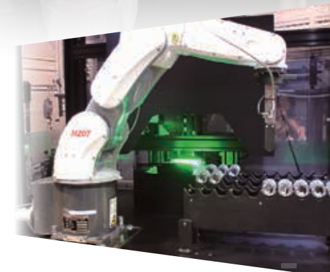
▲ 神基自動化瑕疵檢測系統搭載微軟 Windows 10 IoT Enterprise 解決方案，連結並控制所有的關鍵要素包括機器手臂、感測器，以及步進馬達。
